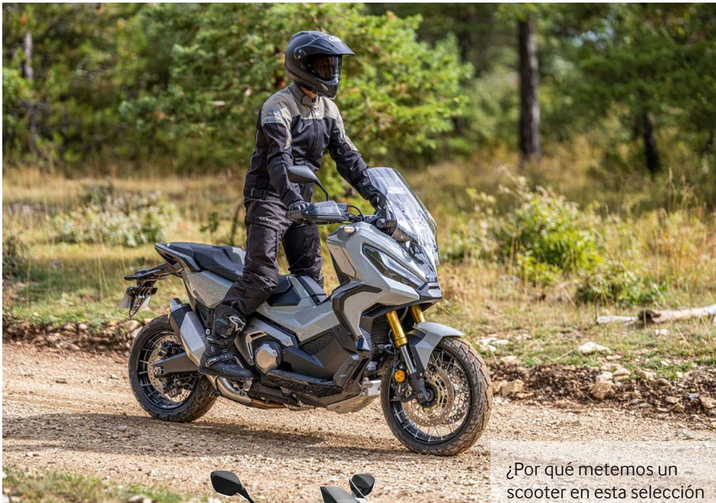
¿Por qué metemos un scooter en esta selección de motos trail? Porque Honda tiene el primer scooter con dotes off road del mercado, con suficiente potencia y calidad de conducción dentro y fuera de carretera como para que te plantees si ésta no es tu moto trail. El motor de este scooter es un bicilíndrico con sistema doble embrague DCT (no tiene variador de velocidad como los scooter tradicionales). Las suspensiones y protecciones del X ADV te permitirán ir bastante bien por caminos.
